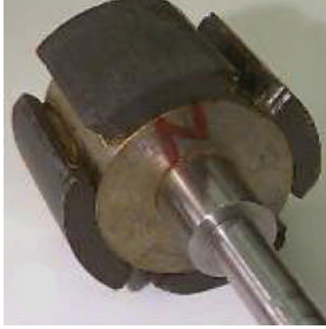
Fotoğraf 4.3: Doğal mıknatıslı rotor
