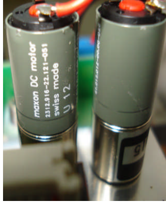
Fotoğraf 4. 5: Koagulometrede kullanılan DC motorlar
