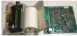
Resim 4.4: Termal yazıcı ve kontrol ünitesi
