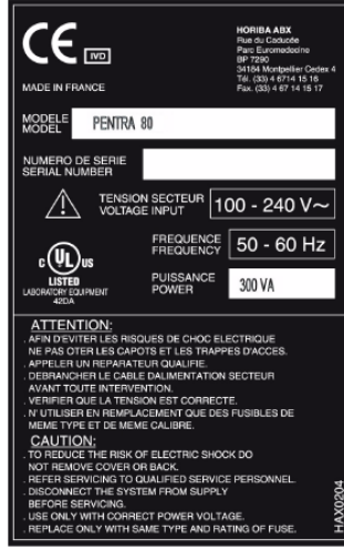
Resim 1.3: Cihazın arka kısmında bulunan tanımlama etiketi
