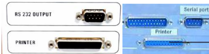
Resim 4.5: Kan sayım cihazı yazıcı portu
