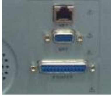
Şekil 4.3: Hastabaşı monitör net, crt ve haricî printer bağlantı noktaları
