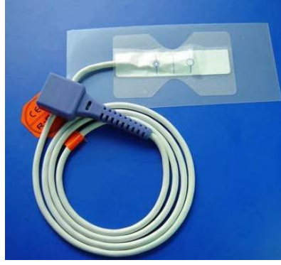
Resim 2.3: Hastabaşı monitor ile kullanılan SpO 2 probu
