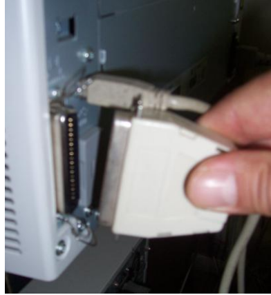
Şekil 4.2: Hastabaşı monitör haricî yazıcı paralel port bağlantısı
