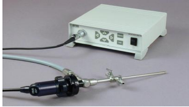
Resim 2.1: Kamera kafası ve kamera ünitesi(CCU),(kamera kafasına rijit teleskop bağlı)
