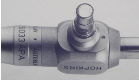
Resim 4.3: Teleskoptaki soğuk ışık bağlantı noktasındaki yüzeyin kontrol edilmesi
