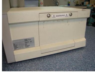
Resim 3.10: Lambanın Bulunduğu kısımda ayrı bir kapak
