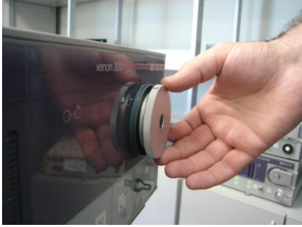
Resim 3.3: Fiber kablonun takıldığı adaptörün çıkarılması
