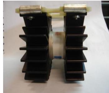
3.12: Xenon lambaların takılı olduğu soğutucular
