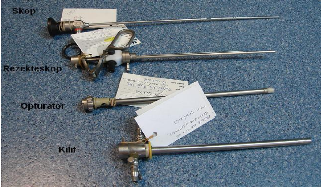
Resim 4.12: Teknik serviste arızalı teleskop(skop), kılıf, rezekteskop ve optirator
