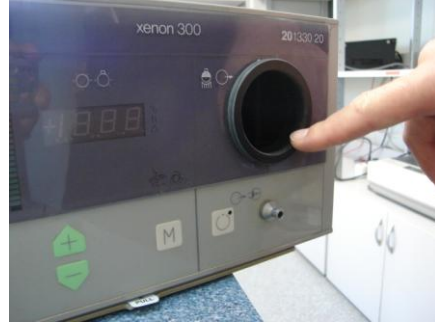
Resim 3.4: Adaptörün çıkarılması ile gösterilen kısımdan ışık ve ısı yayılması
